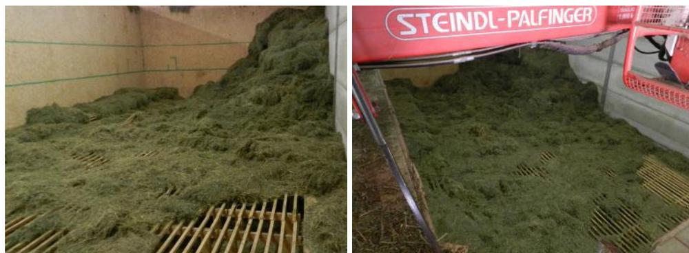
**Figure 4.4** : Séchage du foin en grange : le foin est disposé sur un lattis en bois sous lequel de l'air sec préchauffé à l'énergie solaire passive est insufflé à l'aide de puissants ventilateurs. À droite, à l'avant-plan, on distingue le bras articulé de la griffe nécessaire à la manipulation de grandes masses de foin (© L. Pussemier).
